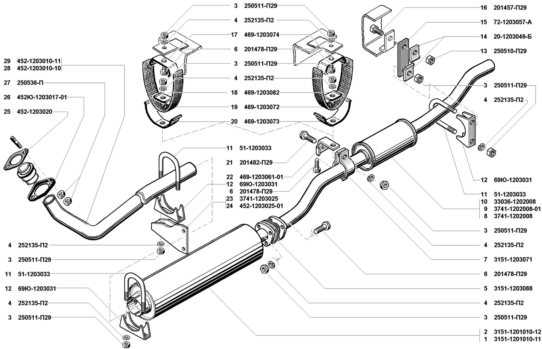
Рис. 29. Глушитель выхлопа (1201), резонатор (1202) и трубы выхлопные (1203)
